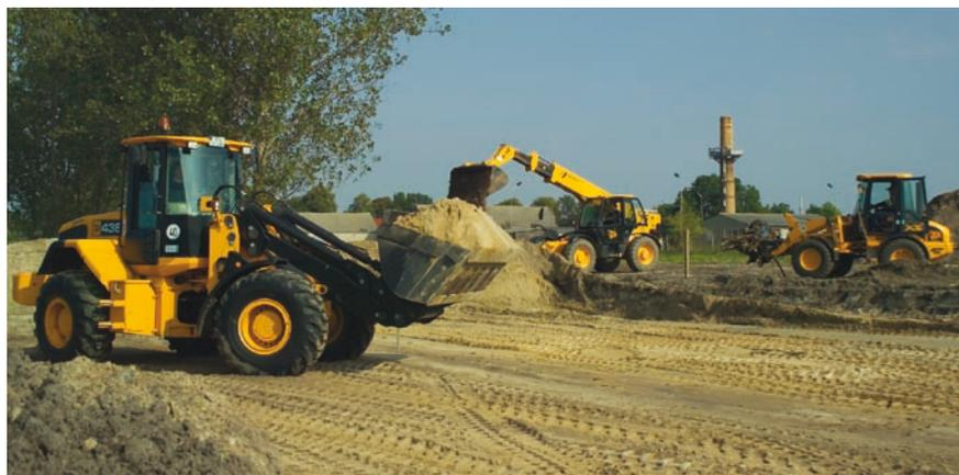
7 Lademaschinen von JCB beim Bau einer Biogasanlage; während ein kleiner Knicklader (rechts) als Stapler fungiert, arbeitet ein Teleskopstapler mit angebauter Schaufel als Radlader
