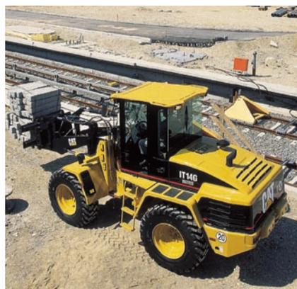
**4 Als Industrielader bezeichnet Caterpillar den 7,9 t wiegenden und 72 kW leistenden IT 14G, dessen Parallelhubarm für den häufigen Wechsel von Anbaugeräten konzipiert ist** Foto: Caterpillar
