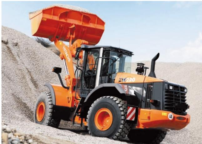
5 Hitachi bietet in Deutschland keine kleinen Radlader, hier der 18 t wiegende ZW 220 mit 2,4 bis 3,5 m<sup>3</sup> Schaufelinhalt und 164 kW starkem Isuzu-Motor
