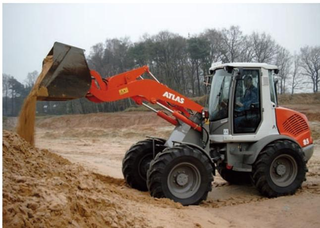
**2 Die Atlas-Knick- und Schwenklader wie der 6,7 t schwere Atlas 85 mit 1,3 m<sup>3</sup> Schaufelinhalt werden nicht von Terex Atlas, sondern von F. Weyhausen in Wildeshausen gebaut**
