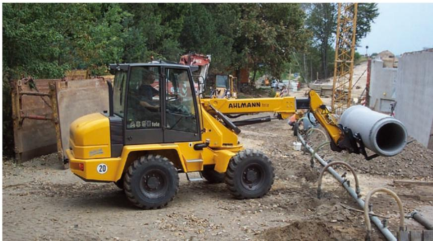
1 Der Ahlmann AS 90 tele reicht Lasten als Schwenklader mit Teleskoparm auch über Hindernisse hinweg und verfügt optional über eine Überlastwarneinrichtung mit Lastanzeige *Foto: Ahlmann*
