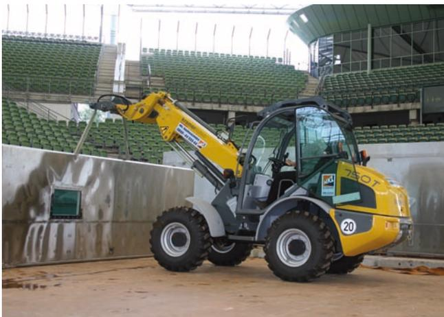
**8 Allradgelenkter Kramer 750T aus dem HKL Mietpark bei Umbauarbeiten im Tennis-Centrecourt in Hamburg; dank Teleskop-Hubarm können Lasten hoch und weit gereicht werden**
