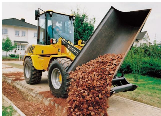
**13** Mit Seitenkippschaufel am Schnellwechsler verfügt der Volvo-Kompaktradlader bequem Gräben und Rinnen; der Lader muss dabei nicht rangieren oder seine schmale Fahrbahn verlassen *Foto: Volvo*
